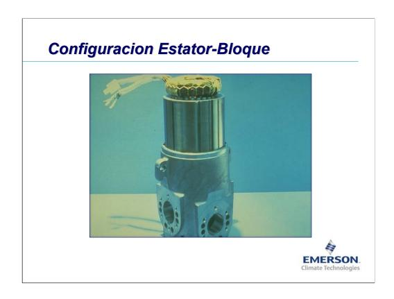
La familia "B" posee una construcción interna particular, si se los compara con el resto de los compresores herméticos Copeland. El Estator está clavado al cuerpo y no atornillado como en el resto de los compresores herméticos. Esto le da una mayor solidez a la unión y permite una mejor disipación de calor en la masa del cuerpo del compresor.
