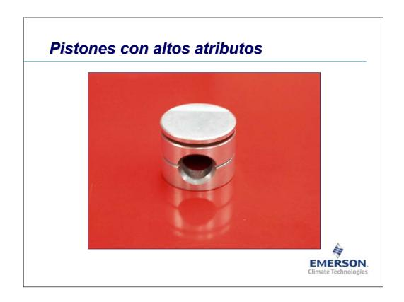
Las nuevas líneas de modelo "C", más eficientes que las anteriores, poseen pistones de aluminio (masa reducida, menor vibración) y aros de fundición (mayor resistencia al desgaste).
