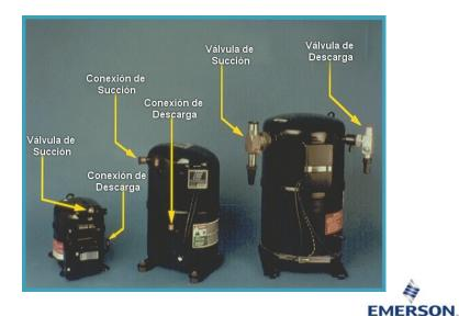
El moto-compresor se encuentra encerrado dentro de una carcasa formada por dos piezas de chapa de acero forjado soldadas entre sí. Su diseño es tal, que ha sido concebido para no ser desensamblado con el propósito de efectuar posibles reparaciones. El motor eléctrico es enfriado por los gases de la succión en todos los modelos. La carcasa se llena con dichos gases, que son posteriormente conducidos a los cilindros, comprimidos y descargados fuera del compresor hacia el condensador.
