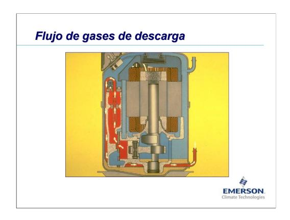
El flujo de los gases comprimidos se realiza a través del "Muffler" de descarga, luego internamente por tubería en la zona del cárter hasta salir del compresor por la conexión de descarga.
