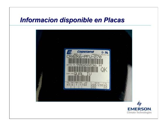
Aquí puede verse el formato de las etiquetas de los compresores de la línea "CRK\*6". Obsérvese que la nomenclatura incluye la capacidad del compresor en condiciones ARI a 60Hz (42K = 42.000 Btu/Hr).
